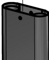
4.2.1. В левую, правую стойки (поз. 10, 11) снизу вкрутить ножки черные (поз. 1, пакет №8), см. рис. 3.
