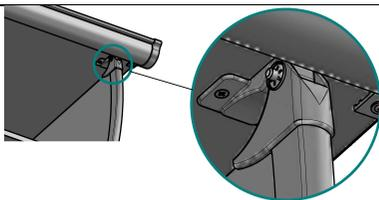
4.8. Установка фиксатора столешницы, для фиксатора BED HINGE DELTA 200.
