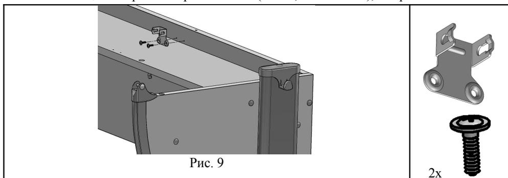
4.4.3. Фиксатор столешницы Multiflex (поз. 1, пакет №9а) нижней частью ввести в кронштейн нижний. (Согласно рис. 9а; 9б)
